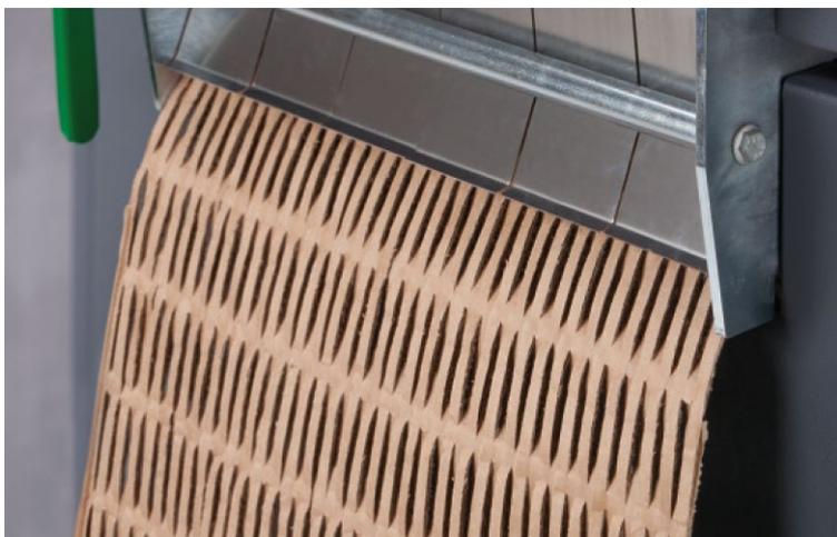
Creación de material de relleno flexible (HSM ProfiPack P425).
